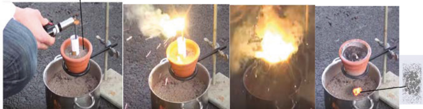
Photos de l'aluminothermie
